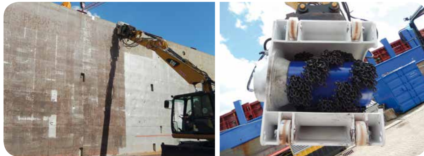
Baggerbaugerät zum Reinigen von Metalloberflächen Beim Benutzen der EXRUST-Fräsen ist Gehörschutz zu tragen.
